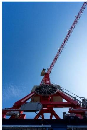
Aufgrund der beengten Verhältnisse waren clevere Lösungen bis ins Detail gefragt. Die Kabeltrommel fand an der Außenseite des Portals Platz.
