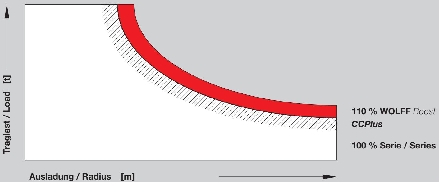
WOLFFKRAN ermöglicht 10 % mehr Traglast gegenüber bisherigen Lösungen auf dem Markt. Die **WOLFF Boost** Funktion wird ab sofort serienmäßig bei WOLFFKRAN eingesetzt und kann bei Kranen mit neuester Steuerungssoftware nachgerüstet werden. Die Steuerung ermittelt selbstständig, ab wann **WOLFF Boost** dem Kranführer zur Verfügung steht. Beim Annähern an den Abschaltbereich signalisiert die Kransteuerung, dass **WOLFF Boost** aktiviert werden kann.
